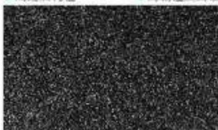
粉末冶金鋼種 微金相組織 Microstructure of PM materials
