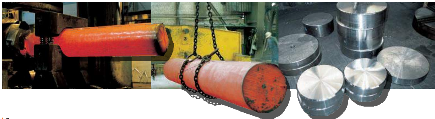
使用 55 MN 開模鍛壓機鍛製圓棒
